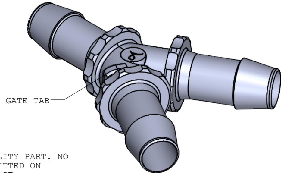
3X INSTRUMENT QUALITY PART. NO PARTING LINE PERMITTED ON THIS CONICAL SURFACE
