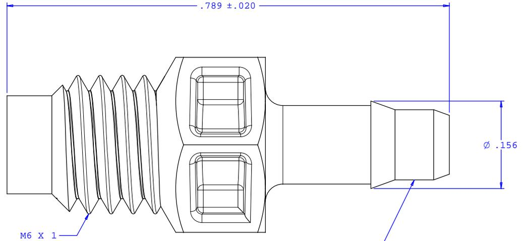
INSTRUMENT QUALITY PART. NO PARTING LINE PERMITTED ON THIS CONICAL SURFACE
