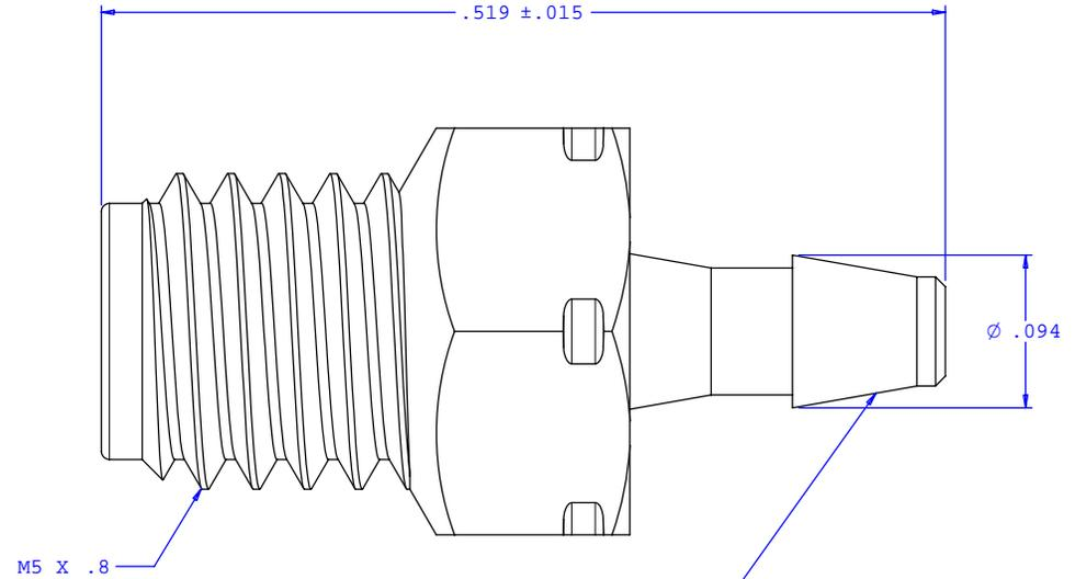
INSTRUMENT QUALITY PART. NO PARTING LINE PERMITTED ON THIS CONICAL SURFACE
